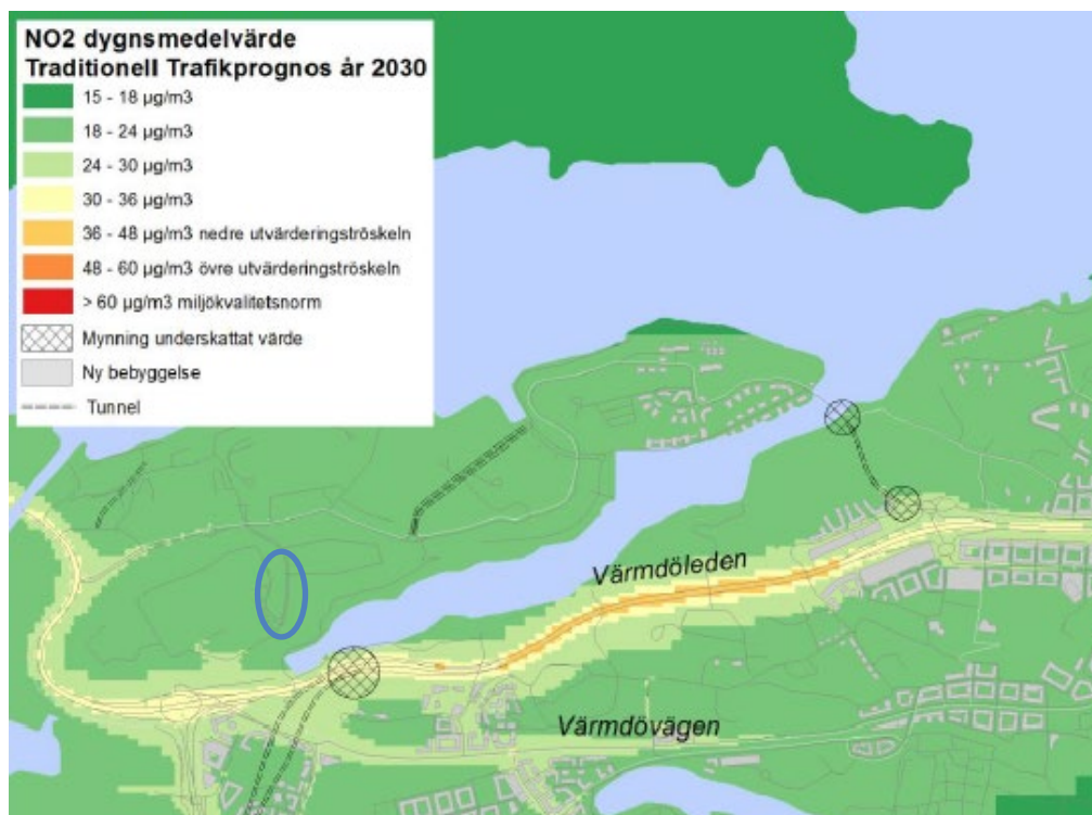
Figur 2. Beräknad dygnsmedelhalt av kvävedioxid, \text{NO}_2 ( \mu\text{g}/\text{m}^3 ) under det 8:e värsta dygnet år 2030. Planområdet är markerat med en blå oval.
